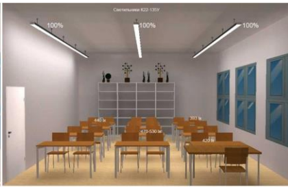
Работа освещения в пасмурную погоду и темное время суток Светильники K22-135У (Т5 1x35Вт) 336 Вт на класс 8,5х6м с датчиками освещенности K2110 или 6,5Вт/кв.м
