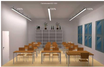
Работа освещения в пасмурную погоду и темное время суток Светильники K22-158У (Т8 1x58Вт) 557 Вт на класс 8,5х6м с датчиками освещенности K2110 или 10,9Вт/кв.м
